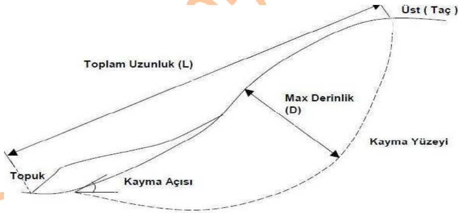
Şekil 1. Skempton'a göre sınıflandırmada şev geometrisi
